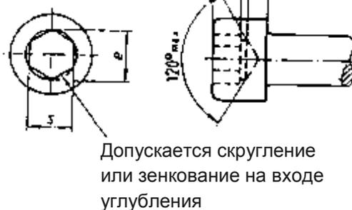
Допускается скругление или наличие фаски на нижнем ребре головки
