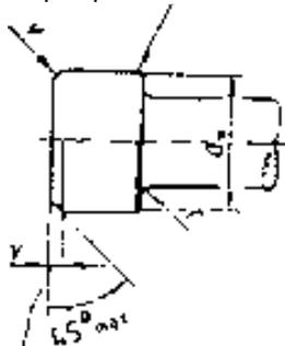
Допускается скругление или фаска на верхней части головки
